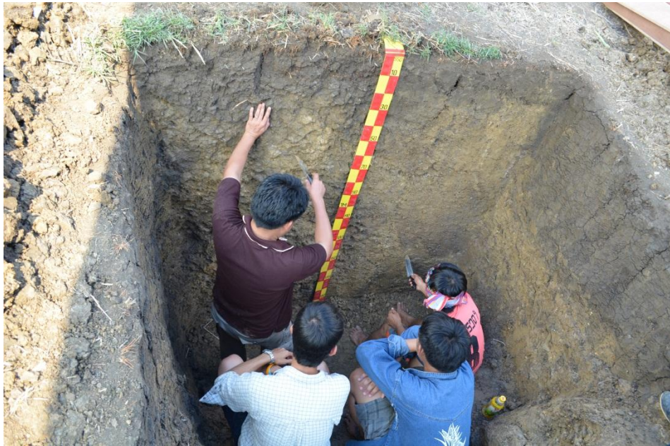
ภาพที่ 2.1 แสดงหลุมหน้าตัดดินลึกประมาณ 2 เมตร หรือถึงชั้นวัสดุที่เป็นหินแข็ง และการตกแต่งหน้าตัดดิน
