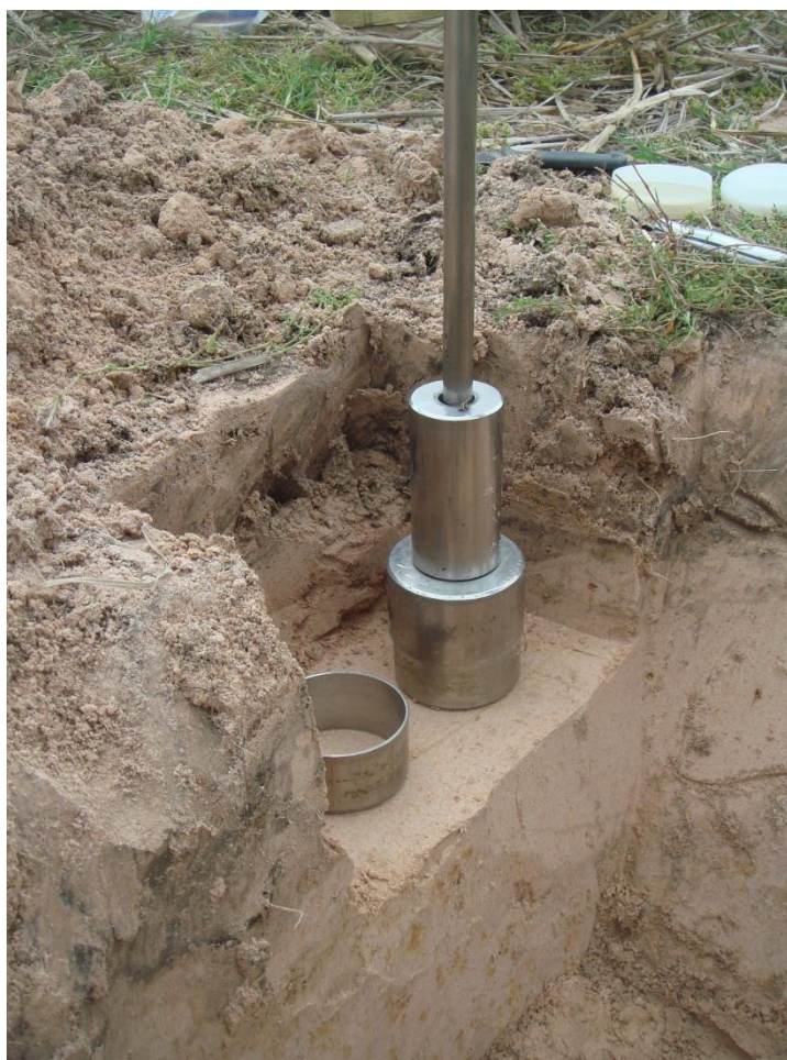
ภาพที่ 2.2 การเก็บตัวอย่างดินด้วยกระบอกกลม (core) แบบไม่รบกวนโครงสร้างดิน ตามชั้นกำเนิดดินภายในหน้าตัดดิน อุปกรณ์และวิธีการเก็บตัวอย่างดินเพื่อการวิเคราะห์ดินทางกายภาพ
